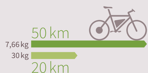
Die Vorläufer der E-Scooter, die E-Bikes der 80er-Jahre, wogen 30 kg und erzielten eine maximale Reichweite von 20 km. Das Volta Montanara ist das leichteste E-Bike der Welt. Es ist aus Carbon, wiegt 7,66 kg und schafft 50 km. (Quelle: e-bike-news.de, greenfinder.de)
